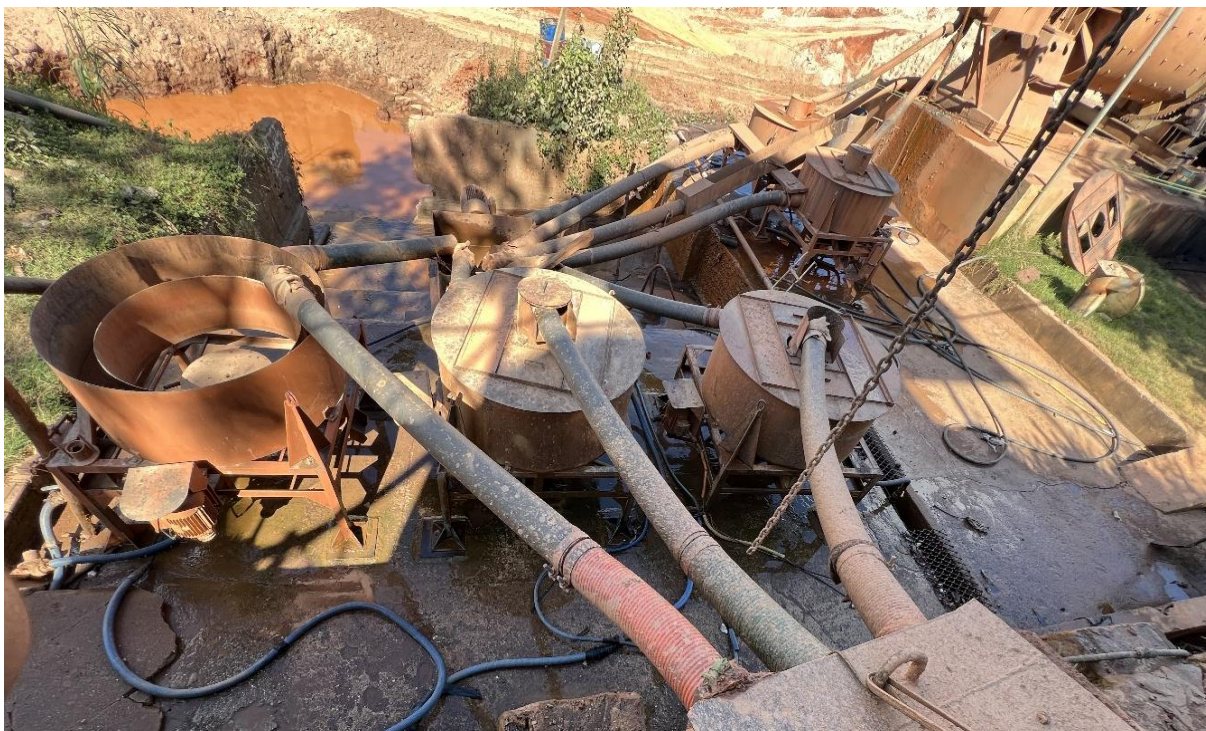
Figura 57. Concentrador centrífugo utilizado em lavra de bancadas
