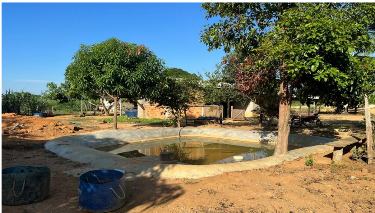
Figura 81. Exemplo de poço com cimento para amalgamação
