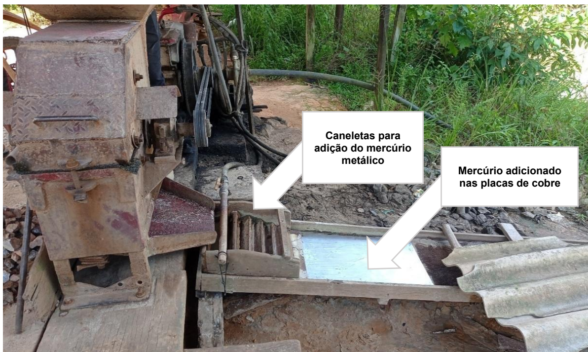
Figura 68. Moinho com placas de cobre coberta com mercúrio
