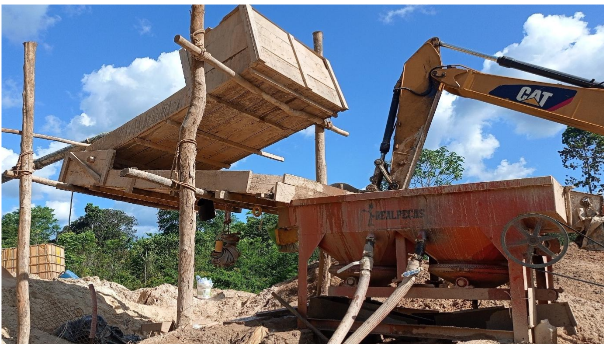
Figura 58. Jigue acoplado na calha concentradora para separação de tantalita
